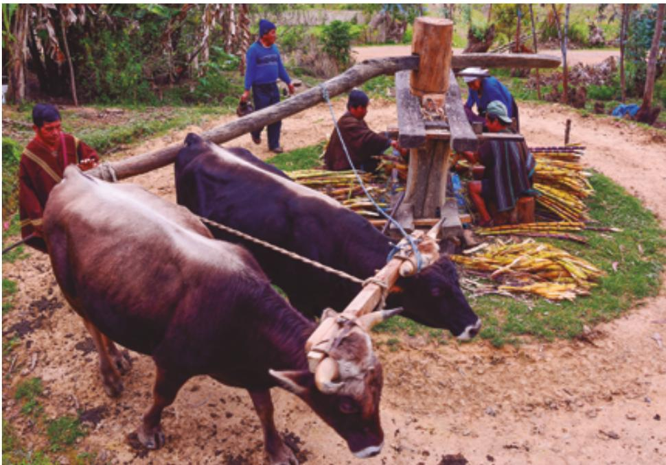
Figura N° 33: empleo de tecnologías tradicionales para el tratamiento de la caña de azúcar.
